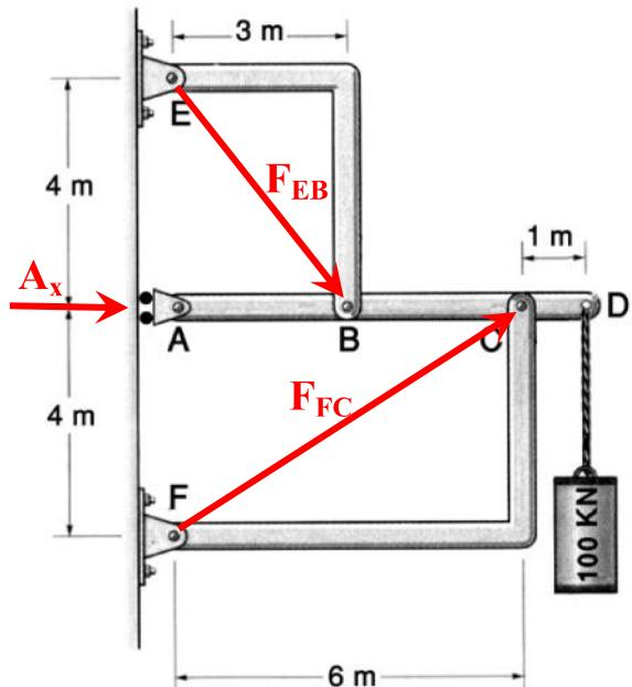
۱- در شکل مقابل سه عضو ABCD و EB و FC توسط تکیه گاههای مفصلی E و F و تکیه گاه غلطگی A و مفصلهای B و C برای تحمل یک بار ۱۰۰ کیلونیوتونی تشکیل یک سازه پایدار را می دهند. عکس العملهای تکیه گاهی این سازه را بیابید.
