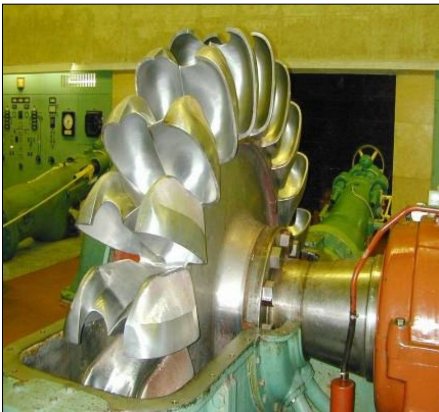
شکل ۴-۱: نمونه ای از توربین چرخ پلتون
