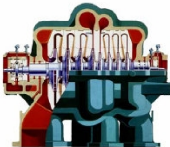
شکل ۵-۵: شماتیک یک کمپرسور با خنک کن میانی
